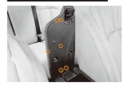
1 フタの裏にあるネジ6箇所をドライバーを 使用して外します。
