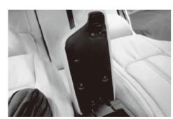
ある程度はめ込む事が出来たらネジで固定します。 ネジの固定後、カバーにたるみがあればへう等で隙間に押し込んで下さい。
