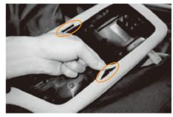
5 カバーが外方向に逃げるのを防ぐ為、両サイドのカバーのフチにハサミ等で切れ込みを入れ、樹脂のツメに引っ掛け固定します。詳しくは6番を参照して下さい。
